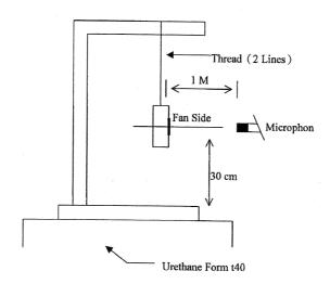
1 METER FROM MICROPHONE TO FAN INTAKE
