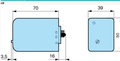
Dimensions (mm) LN connector sockets 8-pin : 25 622 129 11-pin : 25 622 078
