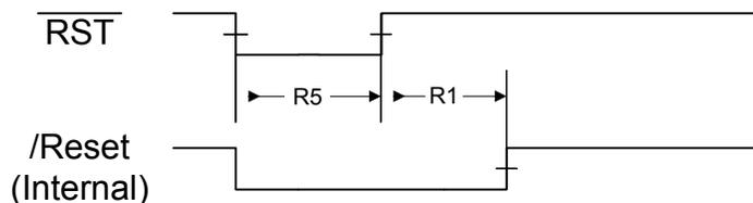
Figure 25-8. Software Reset Timing
