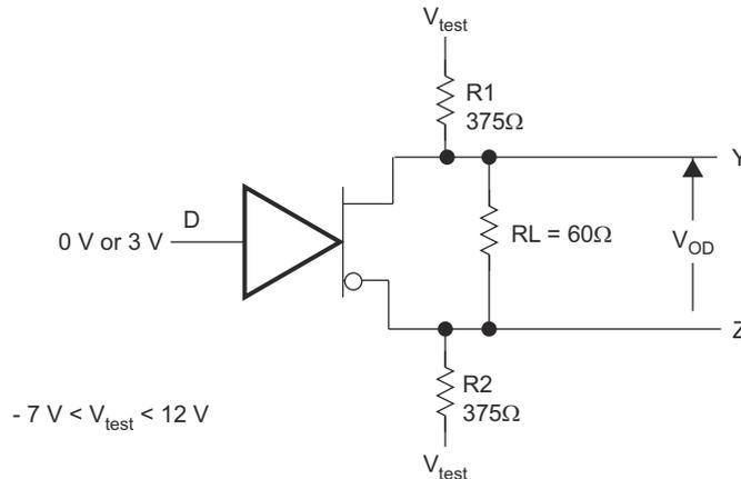
Figure 6-2. Driver  $V_{OD3}$
